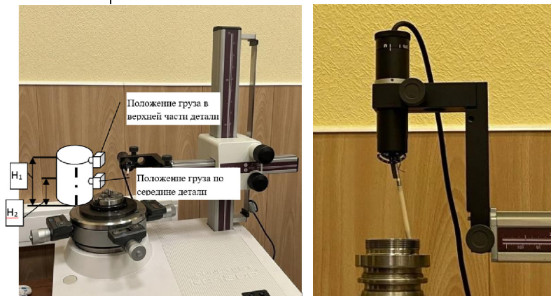
Рисунок 1 – Схема проведения эксперимента (слева), ощупывание детали щупом в верхней плоскости (справа)
